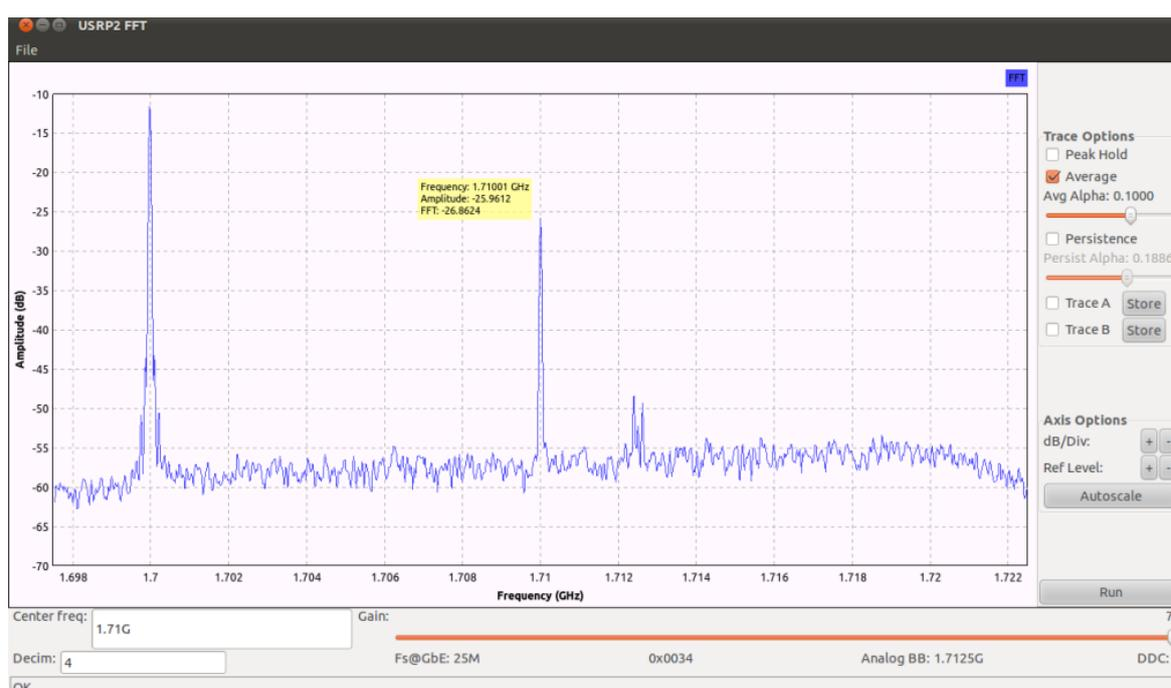
**Figure 48 : Visualisation d'une raie parasite de niveau supérieur au signal mesuré**
