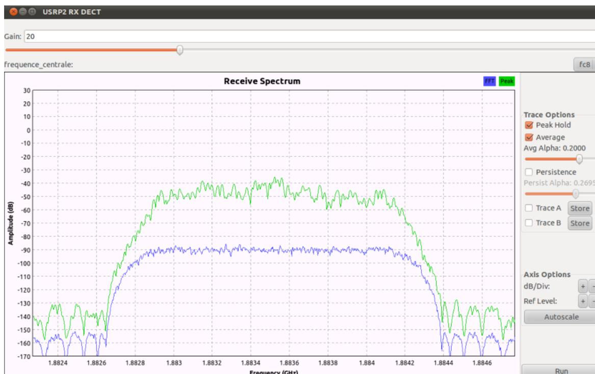
Figure 61 : Effet du filtre de canal FIR
